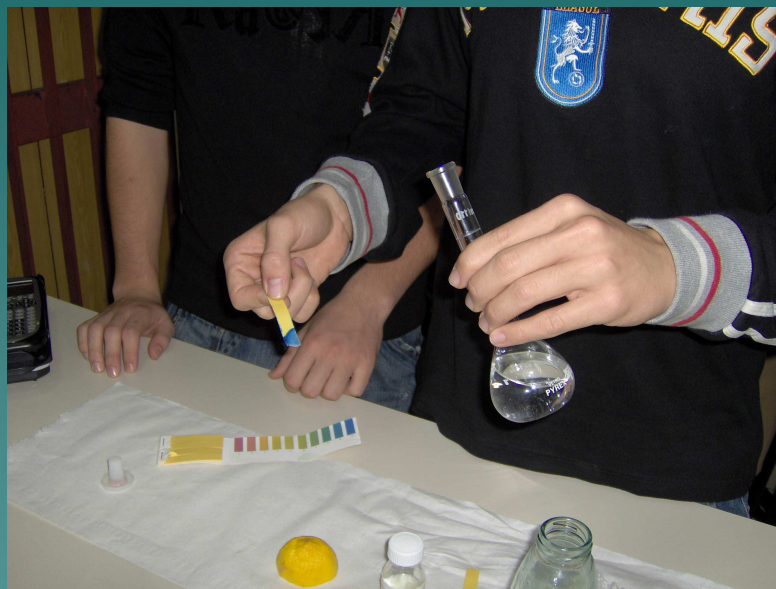
Misura del pH tramite la cartina indicatrice
