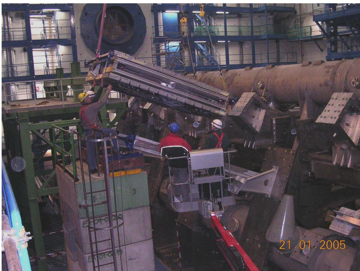
Interno del laboratorio dell'esperimento ATLAS durante il montaggio degli RPC
